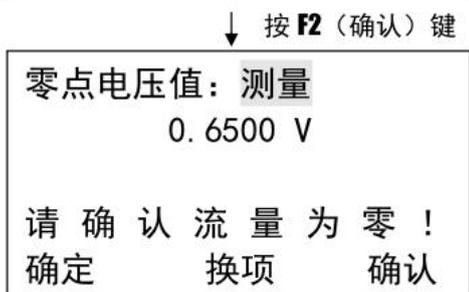
零点电压值, 设置仪表在零流量时的电压值, 并实时显示流量电压值。标定零点时, 请确认管道内无流量, 稳定大约半分钟以上的时间后, 同时按 F1 和 F3 键, 显示界面提示设置零点成功。零点电压值也可手动输入, 在设置零点界面, 将光标移至**流量处**, 按 F3 键改为输入, 将标定的零点电压值输入后, 按 F2 键换项。注: 在使用过程中, 请不要设置零点电压值。
